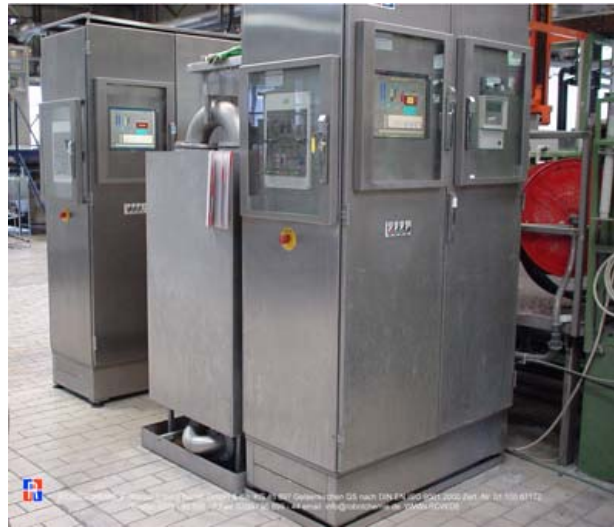
Entfettungsbadrecycling mit Gesamtleistung 400 L/h
