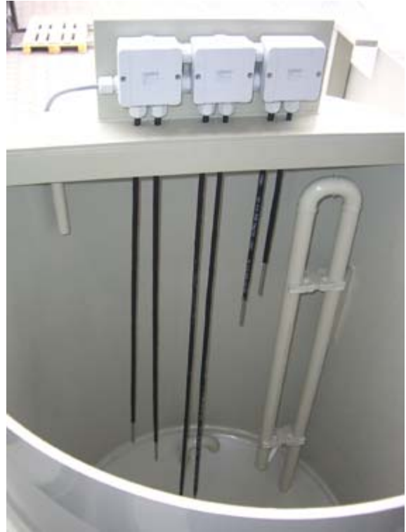
Puffer – und Arbeitsbehälter , Ausführung Aufbereitung von Säurebädern
