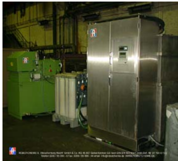
Emulsionsspaltung mit Gesamtleistung bis 600 L/h
