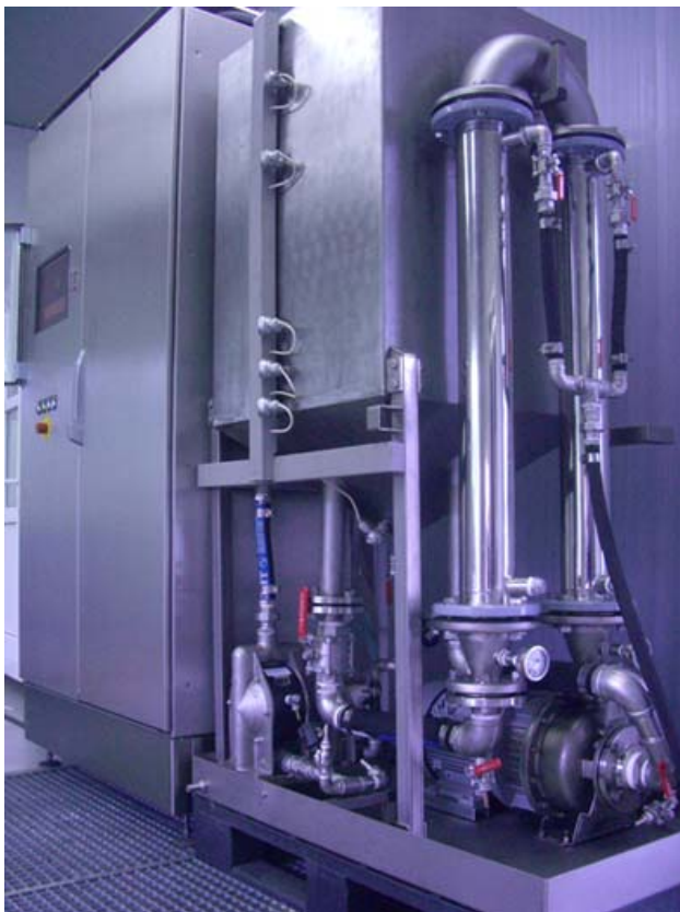
Anlage für die lebensmittelverarbeitende Industrie zur enzymatischen Aufkonzentrierung
