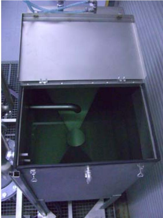
Puffer – und Arbeitsbehälter für die Aufbereitung alkalischer Bäder
